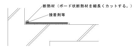
③-2. セルフレベリング材施工後に壁の断熱材を施工
