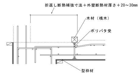
手順② スラブコンクリート打設、養生、解体
