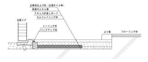
\* 玄関ドア枠部と床仕上げ材の取り合い部は断熱欠損を低減するため目地棒を入れて縁を切り、仕上げでシーリングで処理することをおすすめします。
