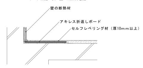
※ 断熱欠損部をカバーするための断熱材どうしの目地部は、アキレス折返しボードの目地部分と同様にクラック防止のファイバーテープを張付けてからセルフレベリング材を施工してください。
