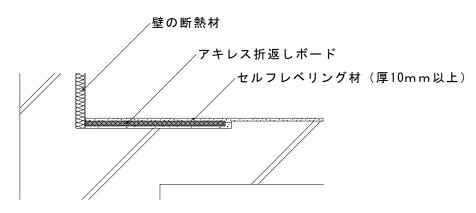
納まり例②: アキレス折返しボード → 壁の断熱材 → セルフレベリング材 の場合
